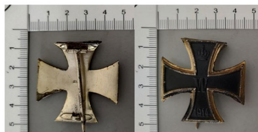
Figura 3: Anverso e verso do exemplar 1, "Cruz de Ferro" de primeira classe da Primeira Guerra Mundial. Notar o dano existente no braço superior da condecoração, onde foram detectados os elementos Pb e Sn através da análise de XRF.
